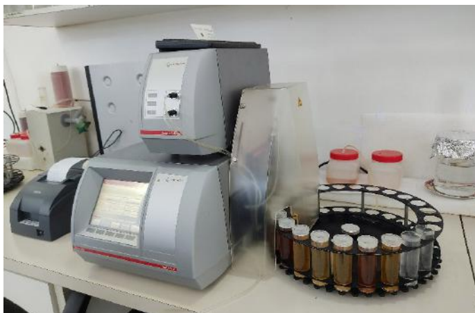
Slika 7. Anton Paar Alcolyzer Plus (Laboratorija za ispitavanje kvaliteta, Pivara „Trebjesa“)
