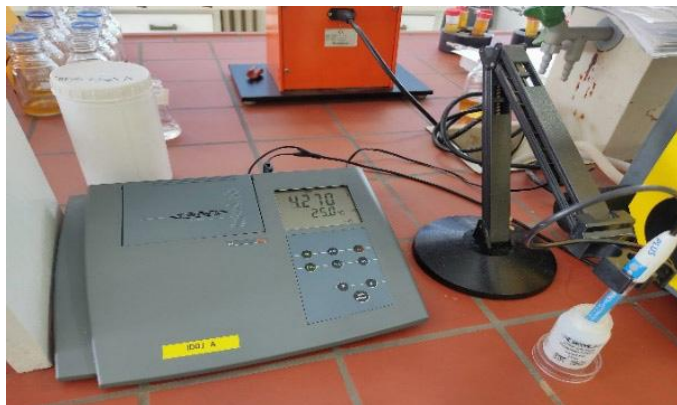
Slika 6. pH mjetar sa elektrodom i rastvorom KCL-a (Laboratorija za kontrolu kvaliteta, Pivara „Trebjesa“)
