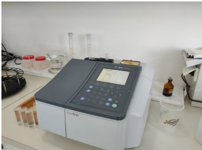
Slika 2. Spektrofotometar UV-1800 (Laboratorija za kontrolu kvaliteta, Pivara „Trebjesa“)
