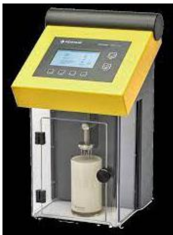
Slika 5. NIBEM uređaj za mjerenje stabilnosti pjene piva
