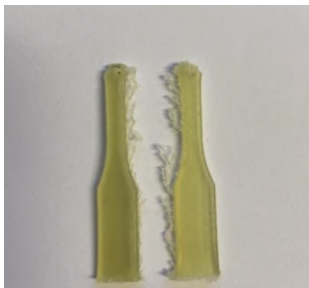
Slika 16. Donja polovina epruvete, do momenta pojavljivanja greške
