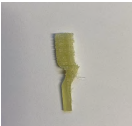
Slika 15. Gornja polovina epruvete sa greškom
